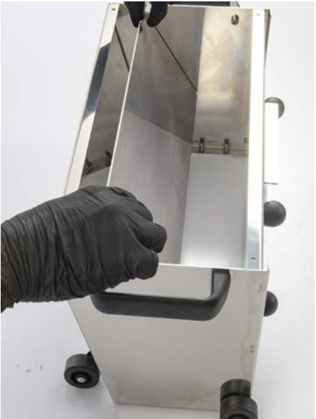
Le réglage peut être effectué directement sur l'échelle de mesure F située sur le devant ou à l'aide des cales G fournies avec l'appareil. Relâcher la guillotine jusqu'à la fermeture totale.
