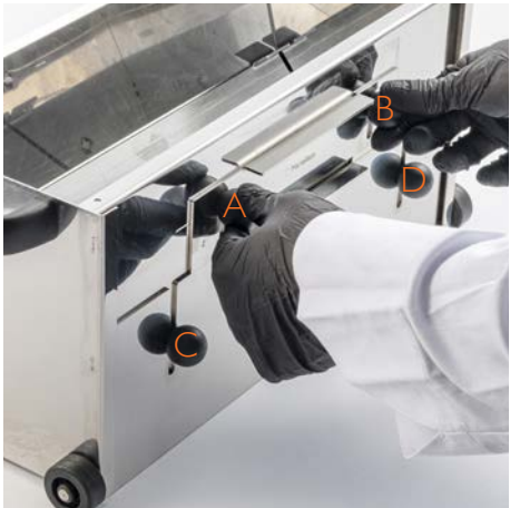
Desserrer les quatre boutons de fixations A-B-C-D.
